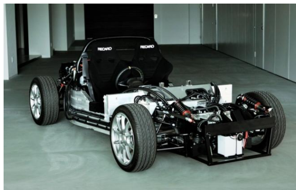
開発した試験車両 8月より走行試験開始 ※展示は車両後部に FRP の外装を装備した状態です
