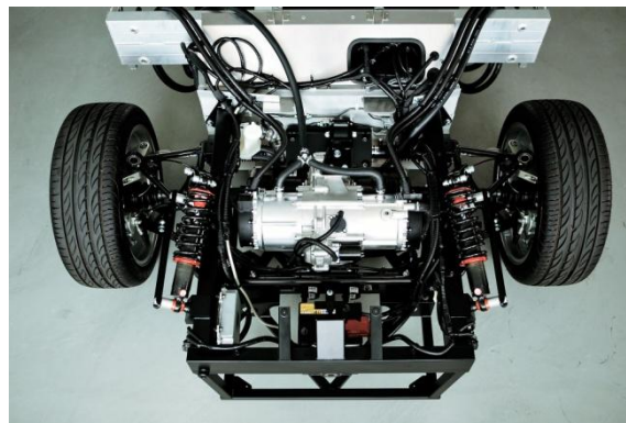
車両のフロント部分 中央が搭載したトランスミッション
