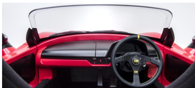
帝人のPCは軽量性・耐久性等が評価されています。 左は高強度生かしたピラーレスの樹脂フロント窓。右は従来のガラス窓
