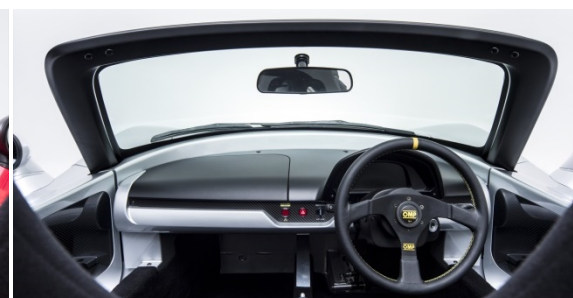
帝人のPCは軽量性・耐久性等が評価されています。 左は高強度生かしたピラーレスの樹脂フロント窓。右は従来のガラス窓
